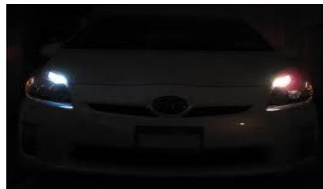
tout véhicule doit être muni à l'avant de deux feux de position émettant vers l'avant une lumière blanche ou jaune, visible la nuit, par temps clair, à une distance de 150 mètres, sans être éblouissante pour les autres conducteurs.
