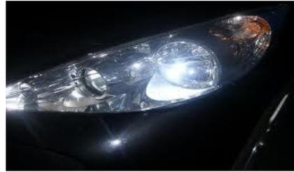
tout véhicule doit être muni à l'avant de deux feux de croisement, émettant vers l'avant une lumière jaune ou blanche permettant d'éclairer efficacement la route la nuit, par temps clair, sur une distance minimale de 30 mètres sans éblouir les autres conducteurs.
