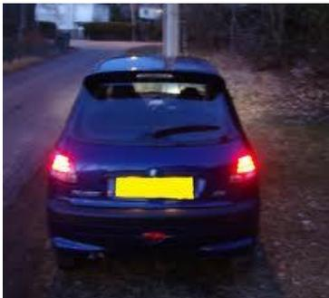
tout véhicule à moteur ou toute remorque doit être muni à l'arrière de deux feux de position émettant vers l'arrière une lumière rouge non éblouissante, visible la nuit, par temps clair, à une distance de 150 mètres.
