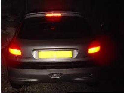
tout véhicule ou toute remorque dont le poids total autorisé en charge est supérieur à 0,5 tonne doit être muni à l'arrière de deux ou de trois feux stop émettant vers l'arrière une lumière rouge non éblouissante. Les feux stop doivent s'allumer lors de l'entrée en action du dispositif de freinage principal.
