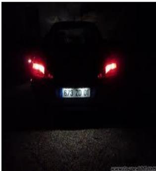
Tout véhicule doit être muni d'un dispositif lumineux capable de rendre lisible, à une distance minimale de 20 mètres, la nuit, par temps clair, le numéro inscrit sur sa plaque d'immatriculation arrière ou sur sa plaque d'exploitation.
