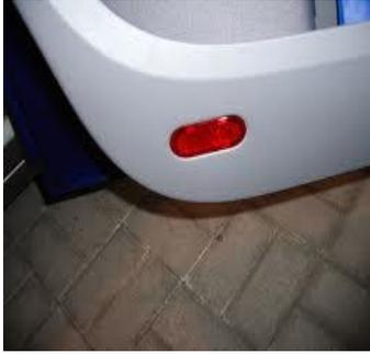
tout véhicule doit être muni de deux catadioptrès arrière rouges, de forme non triangulaire pour les véhicules à moteur et de forme triangulaire pour les remorques.
