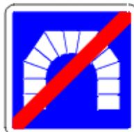
Présignalisation d'une section comportant un tunnel dont l'accès est interdit à certains véhicules transportant des marchandises dangereuses
