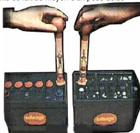
Figure 9 détermination de la densité de l'électrolyte à l'aide d'un pèse-acide
