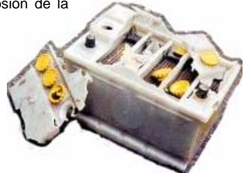
Figure 8 batterie ayant explosé suite à un court-circuit
