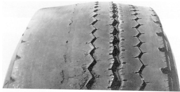
défaut de parallélisme
